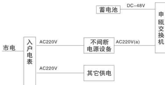
商住楼机房供电方式电源系统组成方框示意图
