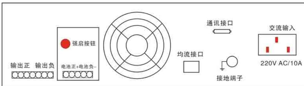
图 3-22 SOC-P4820/1000 电源箱背面板示意图
