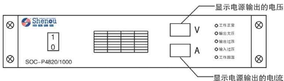
图 3-21 SOC-P4820/1000 电源箱前面板示意图
