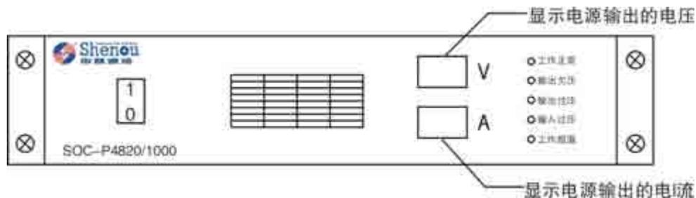
图 3-8 SOC-P4820/1000 电源箱前面板示意图
